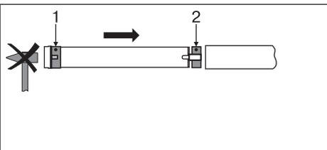
Montieren Sie den Rohrantrieb mit entsprechendem Ring (1) und Mitnehmer (2). Falls der Ring mehrere Nuten besitzt, wählen Sie die passgenaue Nut aus und schieben den Ring (1) auf den Laufring.
